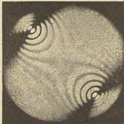
Fig. 94. Achsenbild eines optisch zweiachsigen Kristalles (45° Stellung).
